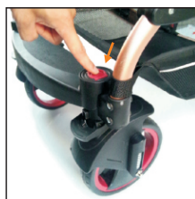
Appuyez sur le bouton pour libérer la roue avant
