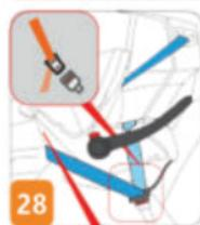
**6.3.** Insérez la languette de la boucle de la ceinture de sécurité (pièce n° 12, page 01) dans la boucle de la ceinture de sécurité du véhicule (pièce n° 13) et écoutez le "clic". (Fig. 28).
