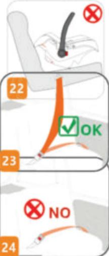
Et à aucun moment, il ne doit être utilisé uniquement avec une ceinture de sécurité à 2 points. Ceinture de sécurité à 2 points. être utilisé. (Fig. 24).
